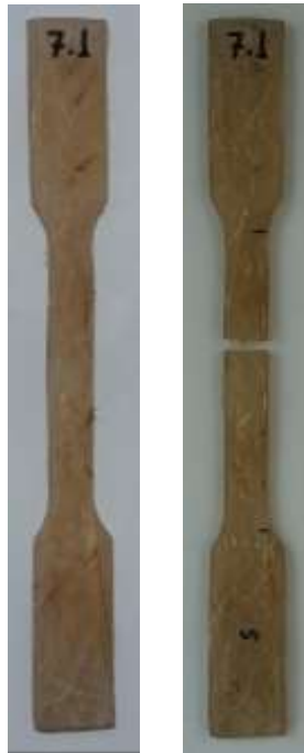
Gambar 4.20 Spesimen Hasil Pengujian Tarik Perendaman 7 Jam
