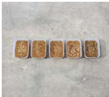
Gambar 4.7 Penuangan NaOH Ke Dalam Wadah Berisi Serat Tebu
