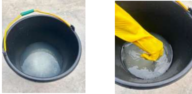
Gambar 4.5 Penuangan NaOH dan Pengadukan NaOH
