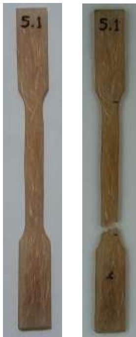
Gambar 4.19 Spesimen Hasil Pengujian Tarik Perendaman 5 Jam
