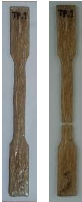
Gambar 4.16 Spesimen Hasil Pengujian Tarik Tanpa Perlakuan Alkali
