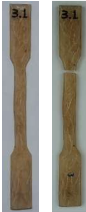
Gambar 4.18 Spesimen Hasil Pengujian Tarik Perendaman 3 Jam
