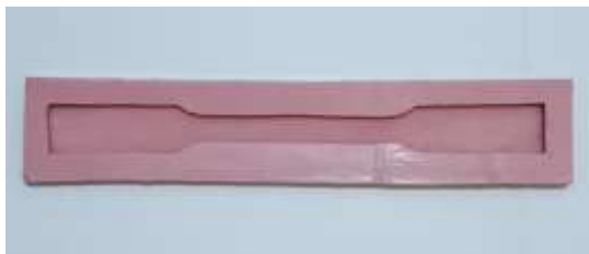
Gambar 3.12 Cetakan Spesimen Uji Tarik Standar ASTM E8
