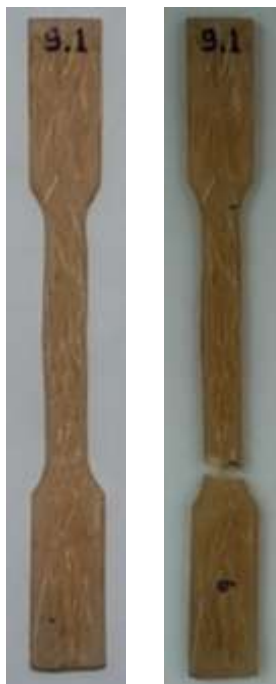
Gambar 4.21 Spesimen Hasil Pengujian Tarik Perendaman 9 Jam
