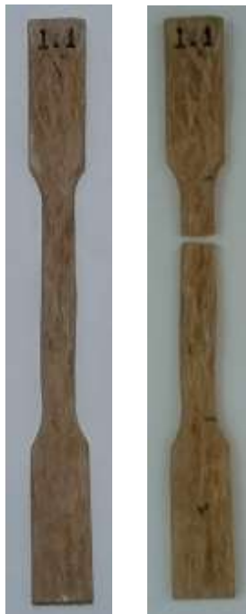
Gambar 4.17 Spesimen Hasil Pengujian Tarik Perendaman 1 Jam
