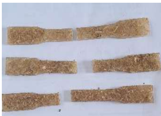
Gambar 4. 3 Spesimen sesudah diuji melalui proses water aging selama 2 jam
