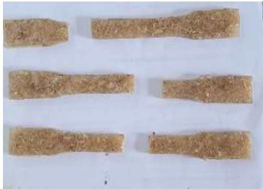
Gambar 4. 4 Spesimen sesudah diuji melalui proses water aging selama 4 jam
