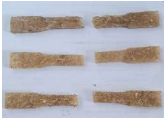
Gambar 4. 5 Spesimen sesudah diuji melalui proses water aging selama 8 jam
