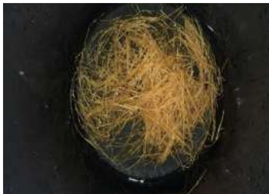
Gambar 3. 18 Proses perlakuan alkali dengan NaOH 5% selama 2 jam
