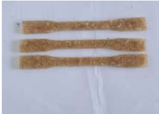
Gambar 3. 22 Spesimen tanpa melalui proses perendaman ( water aging ) sebelum di uji
