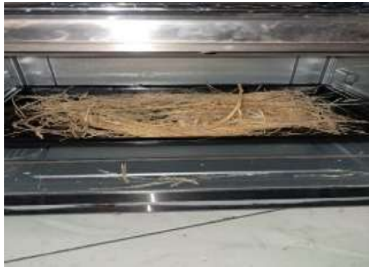
Gambar 3. 17 Proses pengeringan serat ampas tebu dari air bersih
