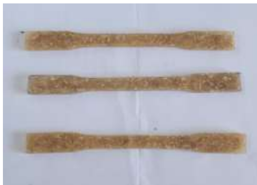
Gambar 3. 24 Spesimen melalui proses perendaman ( water aging ) selama 4 jam sebelum di uji
