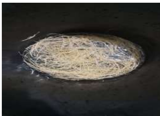
Gambar 3. 16 Proses pembersihan serat ampas tebu dengan air bersih
