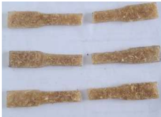
Gambar 4. 2 Spesimen sesudah diuji tanpa proses water aging
