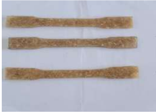
Gambar 3. 25 Spesimen melalui proses perendaman ( water aging ) selama 8 jam sebelum di uji.
