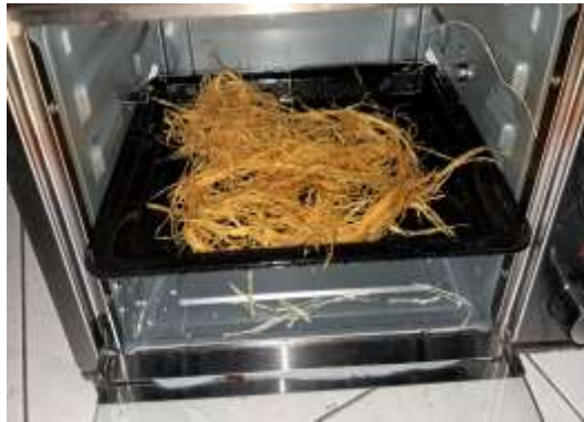
Gambar 3. 19 Proses pengeringan serat ampas tebu setelah perlakuan
