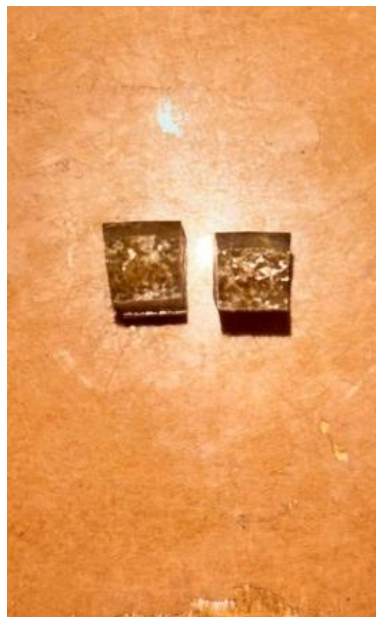
Gambar 4.2 Spesimen sesudah melakukan pengujian impak charpy
