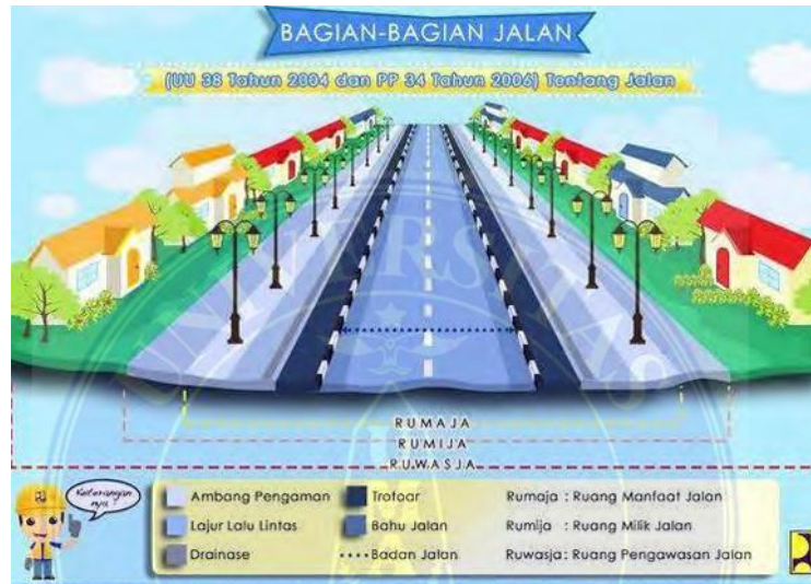
Gambar 2.1 Bagian-Bagian Jalan Berdasarkan UU No. 38 Tahun 2004
