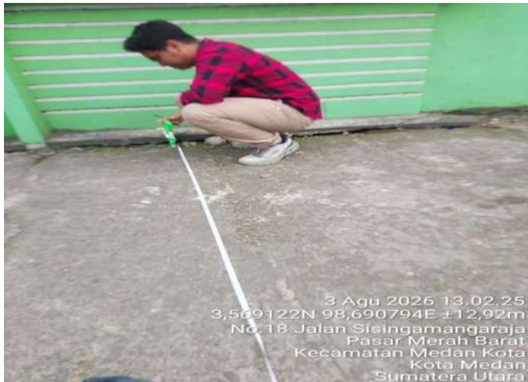
Gambar 1.2: Pengukuran Lebar Trotoar
