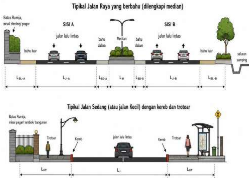
Gambar 2.1: Profil Melintang Jalan (Pengantar Transportasi. 2024)
