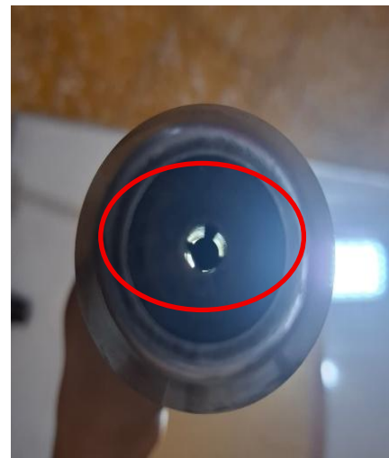
Gambar 4.13 Deposit Karbon pada Ujung Fuel Nozzle
