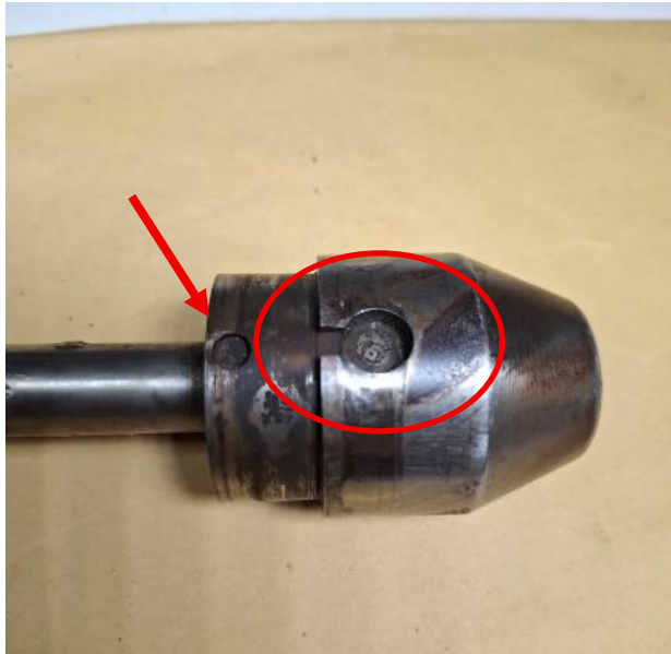
Gambar 4.14 Perubahan Warna Pada Tip Fuel Nozzle
