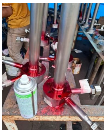
Gambar 2. 5 Fuel Nozzle Mengalami Retakan pada Sambungan Las
