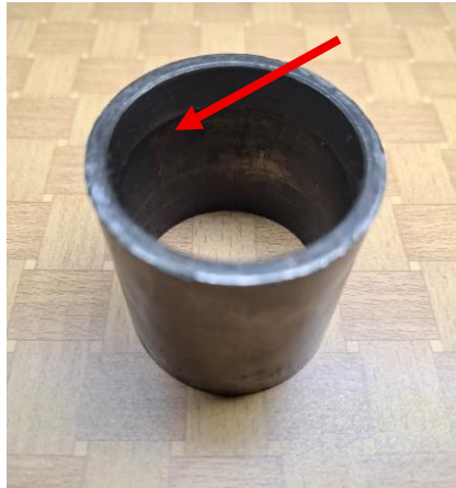
Gambar 4.12 Perubahan Warna Pada Sambungan Fuel Nozzle
