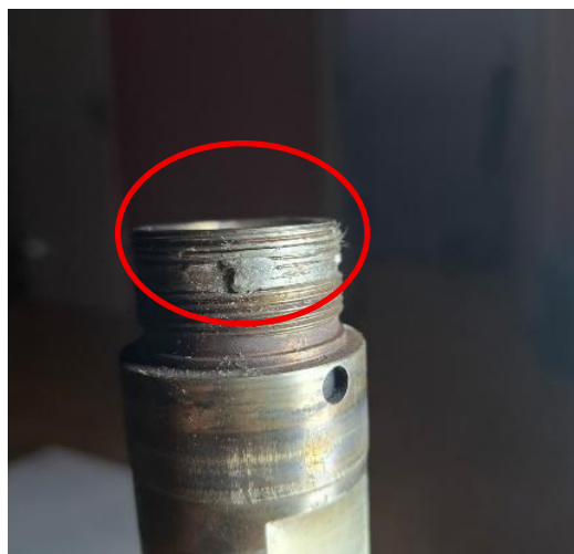
Gambar 4.15 Ulir Fuel Nozzle Mengalami Kerusakan
