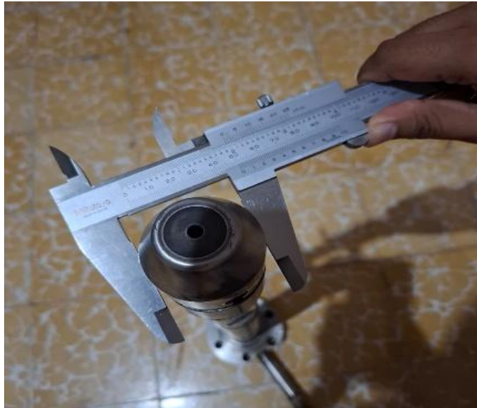
Gambar 4.21 Pengukuran Dimensi Fuel Nozzle
