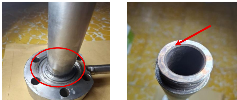
Gambar 4.11 Batang Fuel Nozzle Mengalami Perubahan Warna
