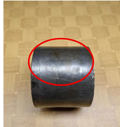
Gambar 4.12 Perubahan Warna Pada Sambungan Fuel Nozzle
