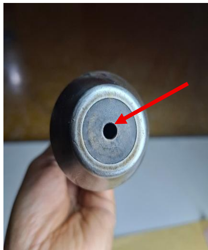
Gambar 4.13 Deposit Karbon pada Ujung Fuel Nozzle
