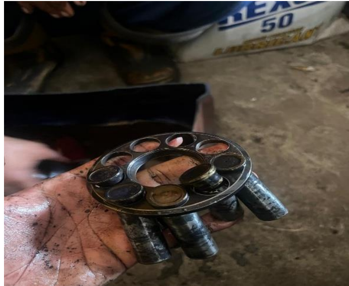
Gambar 4.3 Cylinder block (rotor) setelah dilepas
