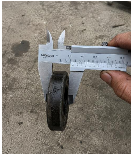
Gambar 4.9 pengukuran ketebalan seal
