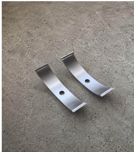
Gambar 4.16 Vane penyekat setelah diganti yang baru
