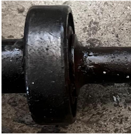
Gambar 4.17 Bearing yang rusak
