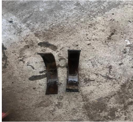
Gambar 4.15 Vane penyekat yang lama
