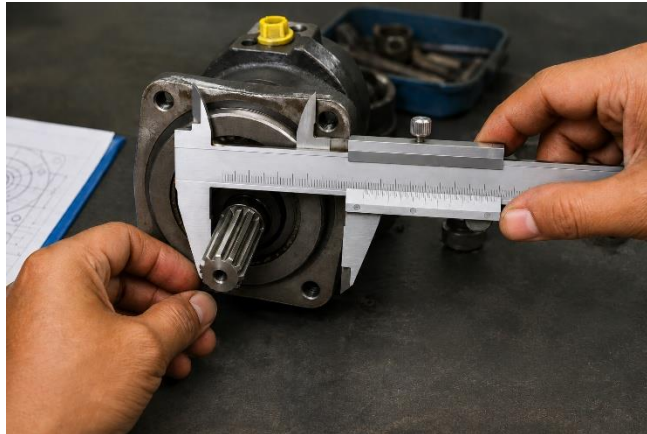
Gambar 4.6 Pengukuran Diameter poros
