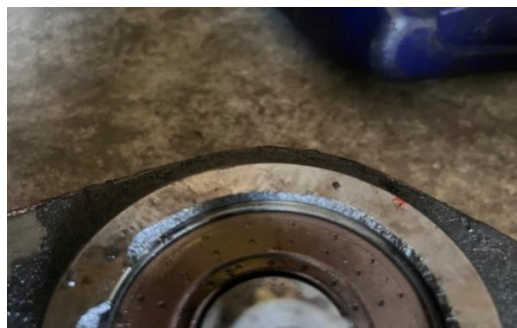
Gambar 2.9 Kontaminsi akibat fluida hidrolik
