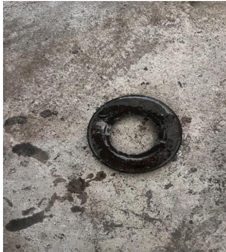
Gambar 4.19 Oil seal yang lama
