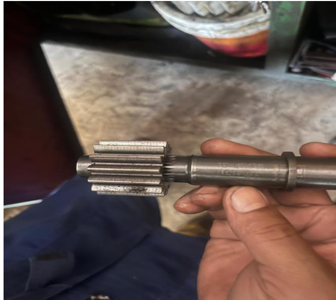
Gambar 4.4 Poros output ( output shaft ) dan gear penggerak
