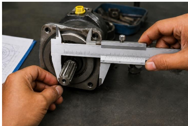
Gambar 3.2 Sigmat atau jangka sorong
