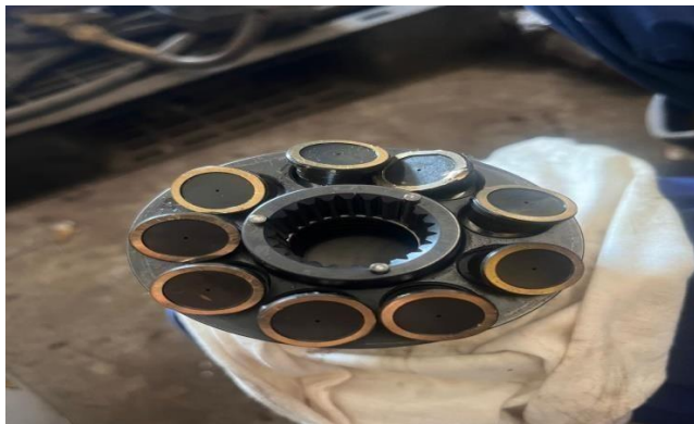
Gambar 2.4 Rotor / Gear / Piston (Elemen Penggerak)
