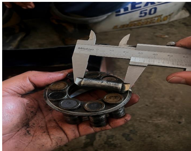
Gambar 4.8 pengukuran elemen penggerak
