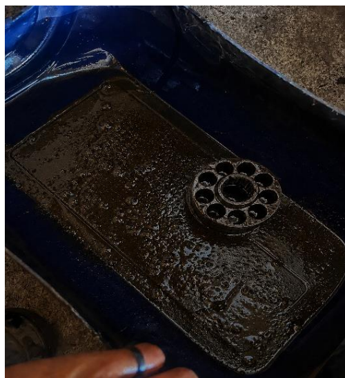
Gambar 4.10 oli yang terkontaminasi
