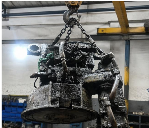
Gambar 4.11 Penarikan Transmisi menggunakan Crane
