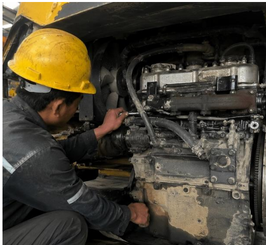
Gambar 4.9 Proses Pelepasan Baut Transmisi dengan Mesin
