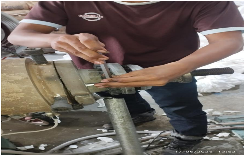
Gambar 4. 8 Perbaikan die head
