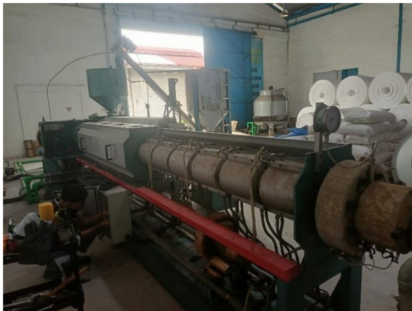
Gambar 4. 7 Perbaikan heater dan sensor
