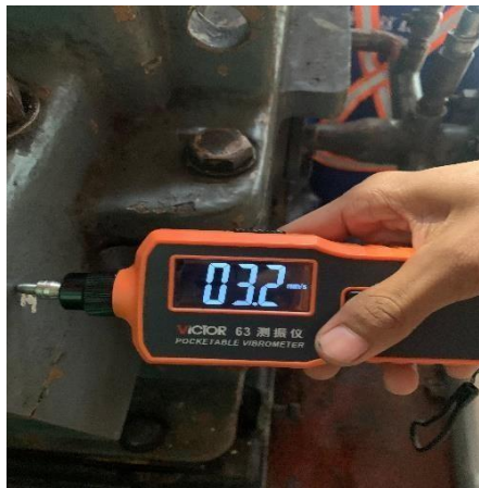
Gambar 4.9 Nilai Vibrasi Setelah Perbaikan
