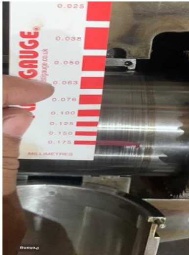
Gambar 4.4 Pengukuran Clearance Pada Bearing Sebelum
