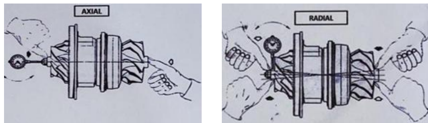
a. Pengukuran menggunakan dial
