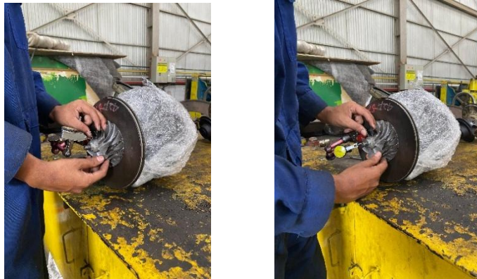
Gambar 4. 10 Hasil pengukuran menggunakan dial sesudah maintenance
