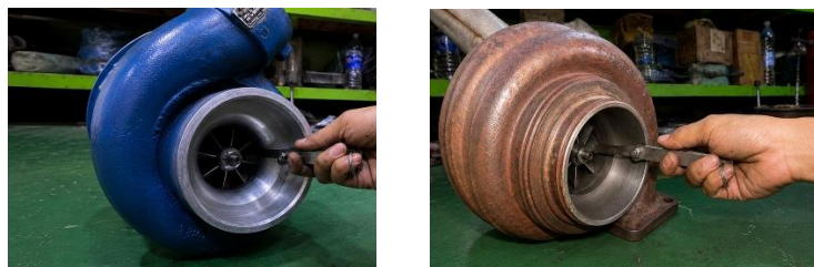
Gambar 4. 9 Pengukuran menggunakan feeler guage sesudah di rekondisi
