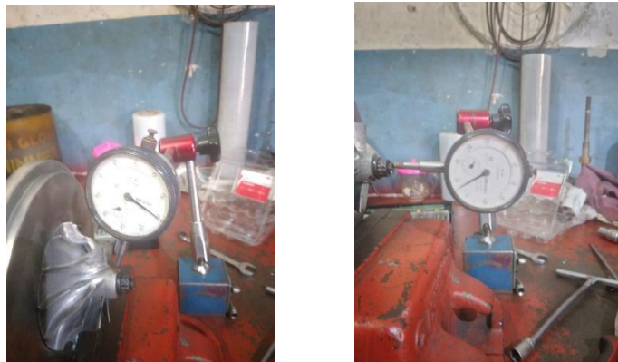
b. Pengukuran menggunakan dial
