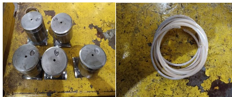
Gambar 4.4 piston dan ring piston
