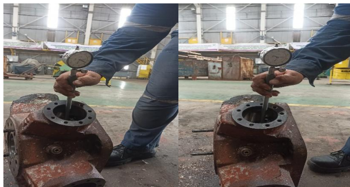
Gambar 4.6 Pengukuran liner piston
