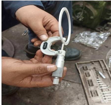
Gambar 4.7 pengukuran ring piston
