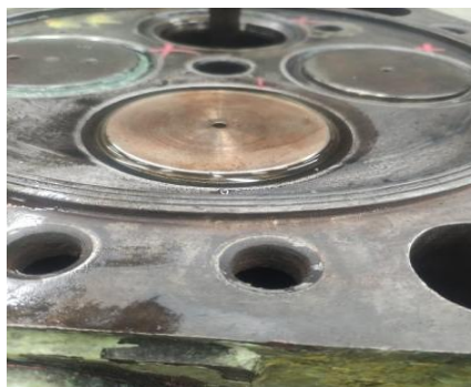
Gambar 3. 7 Tes Kebocoran Valve Seat Memakai Solar
