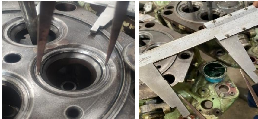
Gambar 4. 2 Pengukuran Valve Seat bagian intake diameter luar
