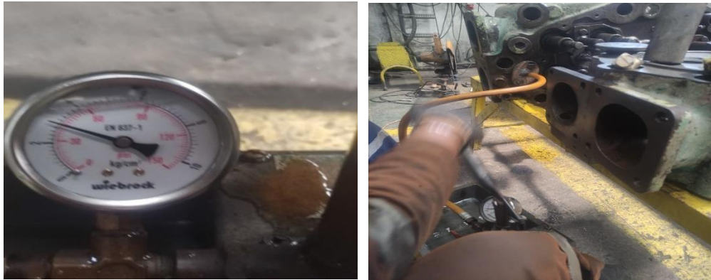
Gambar 4. 11 Melakukan pengujian test press
