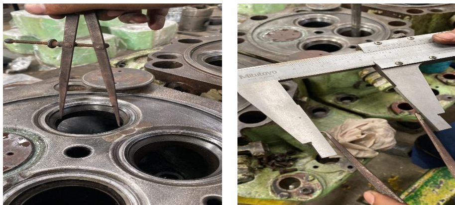
Gambar 4. 9 Pengukuran Valve Seat exhaust diameter dalam
