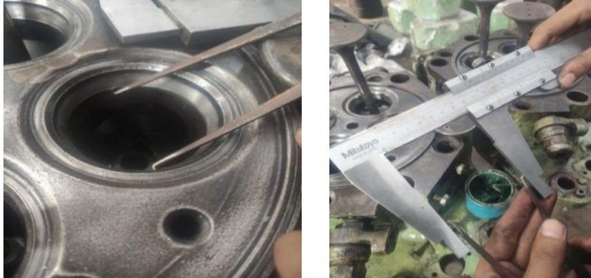
Gambar 4. 4 Pengukuran Valve Seat intake diameter dalam
