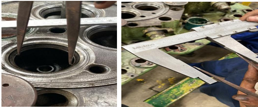
Gambar 4. 8 Pengukuran Valve Seat exhaust diameter dalam
