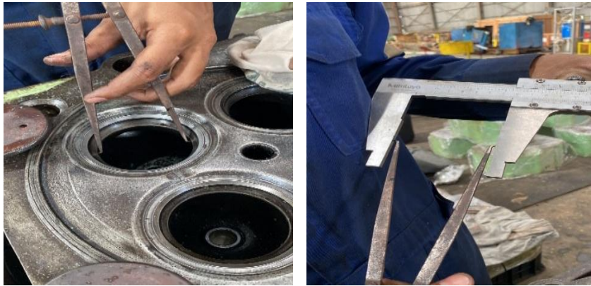
Gambar 4. 5 Pengukuran Valve Seat intake diameter dalam
