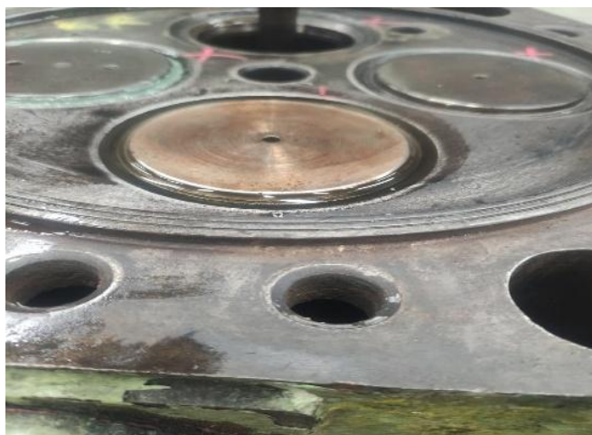
Gambar 4. 12 Melakukan pengecekan kebocoran menggunakan solar
