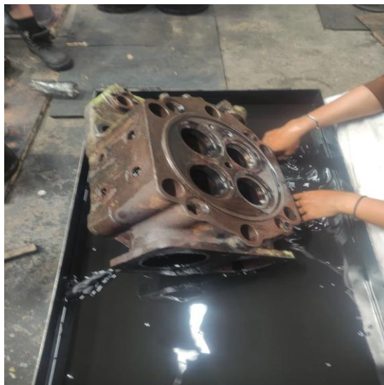
Gambar 4. 1 Cleaning Cylinder Head dari sisa gasket yang menempel
