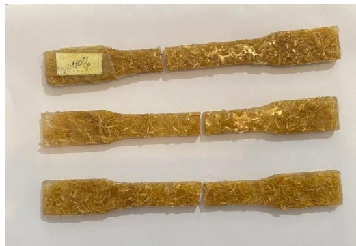
Gambar 4. 6 Spesimen Variasi Volume 40:60 Sesudah Di Uji
