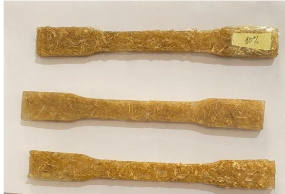
Gambar 4. 8 Spesimen Variasi Volume 50:50 Sebelum Di Uji
