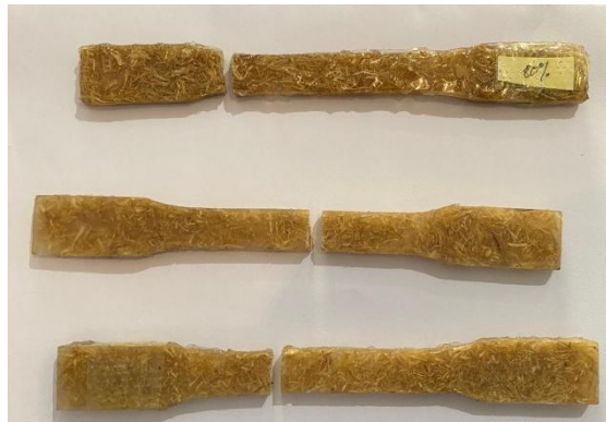
Gambar 4. 9 Spesimen Variasi Volume 50:50 Sesudah Di Uji
