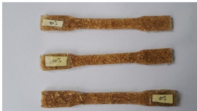
Gambar 3. 24 Hasil Komposit Serat Ampas Tebu
