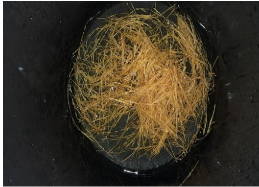
Gambar 3. 17 Proses Perlakuan Alkali Dengan NaOH 5% Selama 2 Jam
