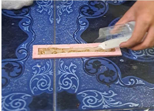
Gambar 3. 22 Penuangan Resin Kedalam Cetakan Yang Telah Diisi Serat
