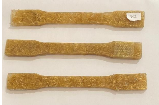
Gambar 4. 2 Spesimen Variasi Volume 30:70 Sebelum Di Uji
