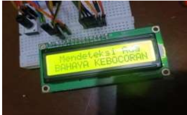
Gambar 4.11 Tampilan LCD ketika terdeteksi bahaya kebocoran gas
