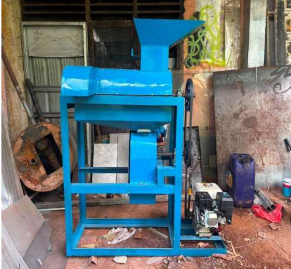
Gambar 2.10 Mesin pemipil dan penggiling jagung
