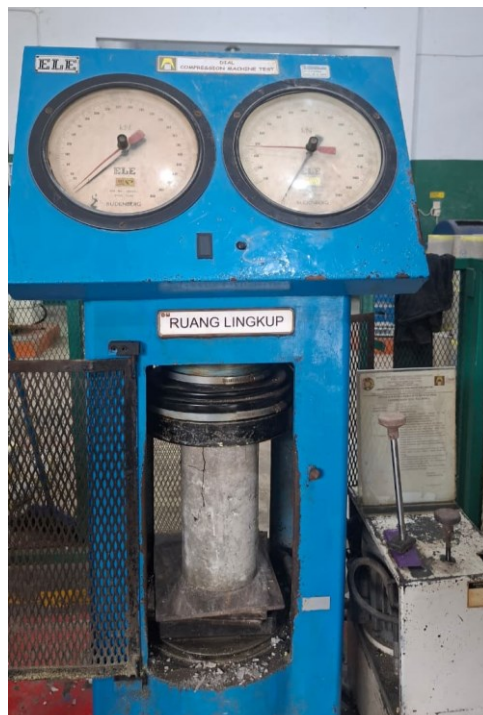
Gambar L.6 : Pengujian Kuat Tekan
