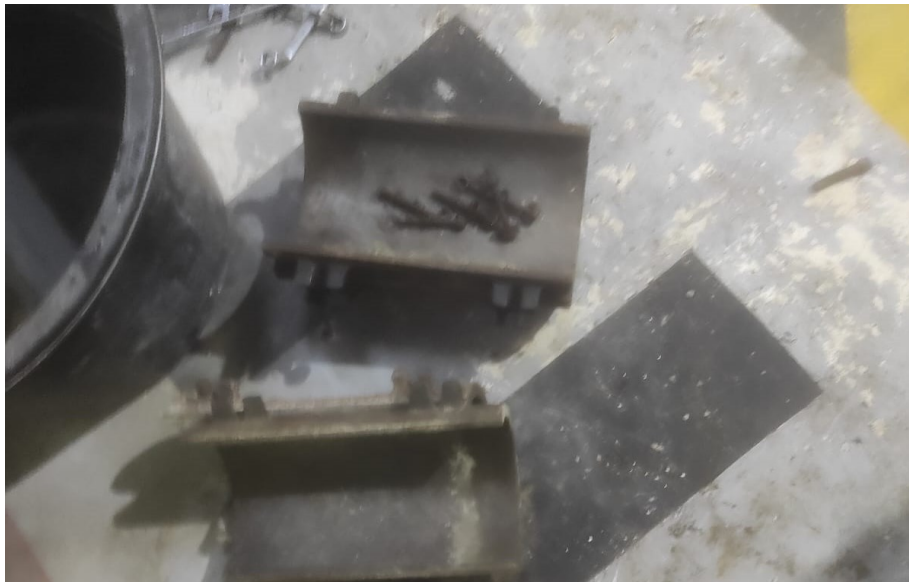
Gambar L.2 : Cetakan Silinder Beton
