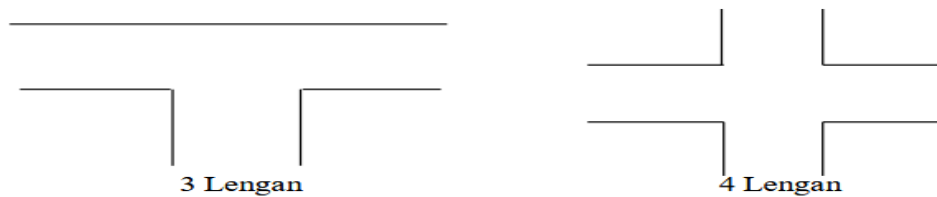
Gambar 2.9: Tipe simpang (Pedoman Kapasitas Jalan Indonesia 2023)
