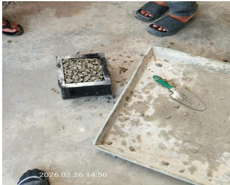
Gambar L- 7: Proses Memasukan Benda Uji Ke Cetakan
