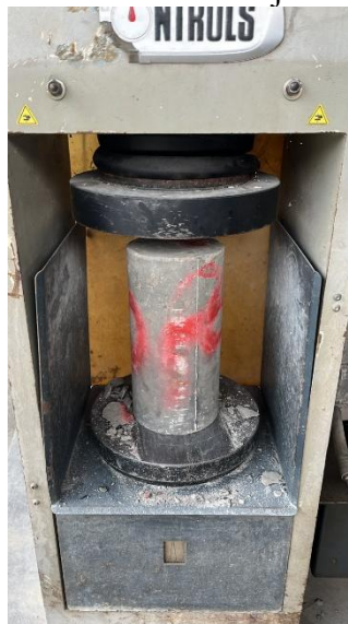
Gambar L.17: Pengujian Kuat Tekan.
