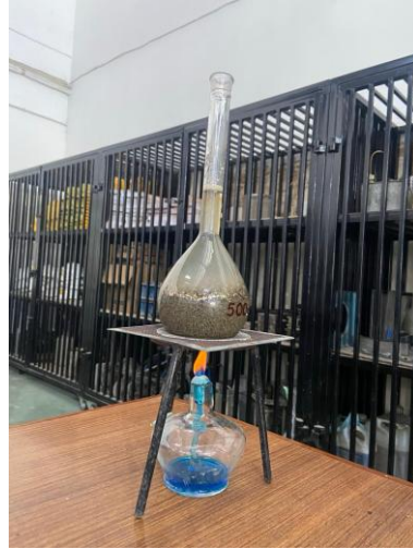
Gambar L.7: Pemanasan Pycnometer Untuk Menghilangkan Gelembung Udara.
