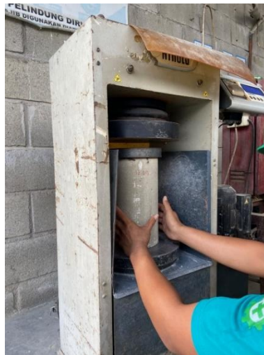
Gambar L.16: Memasukkan Benda Uji Ke Mesin Kuat Tekan.
