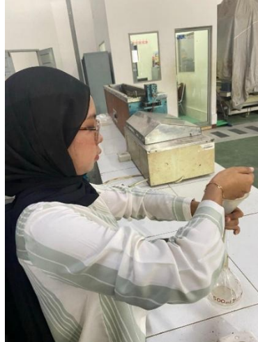
Gambar L.1: Pengujian Berat Jenis Agregat Halus Menggunakan Piknometer.
