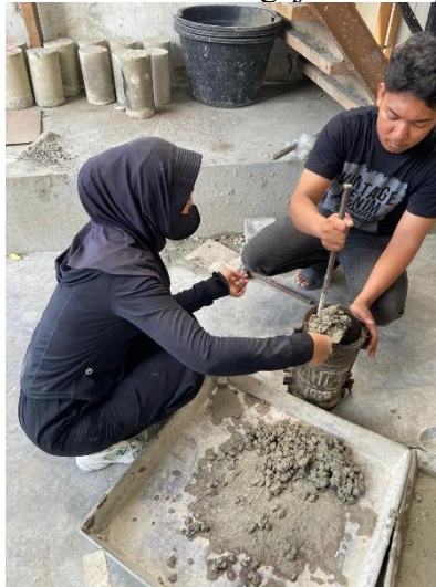
Gambar L.11: Pemasukan Adonan Beton Kedalam Cetakan Silinder.
