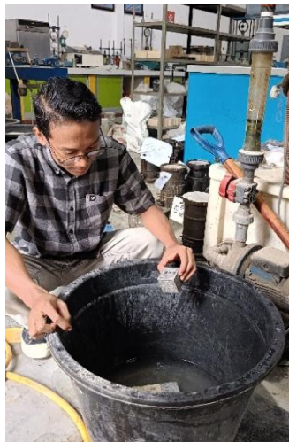
Gambar L.4.39 Memasukkan Mortar ke Bak Perendam
