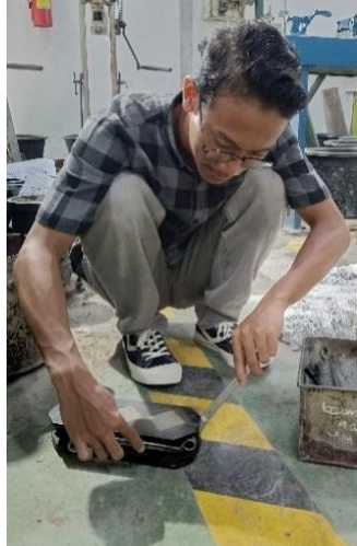
Gambar L.4.37 Membuka Cetakan Mortar
