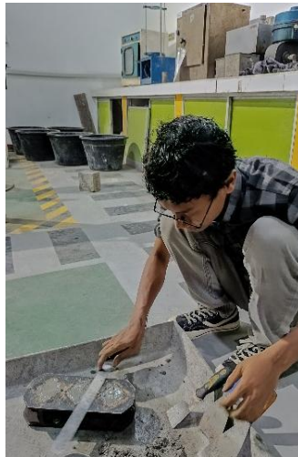
Gambar L.4.35 Meratakan Cetakan dengan Mistar
