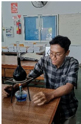
Gambar L.4.15 Memanaskan Piknometer ACS dan ACK
