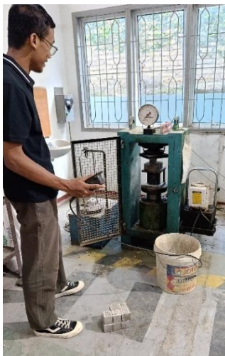
Gambar L.4.42 Pengujian Kuat Tekan
