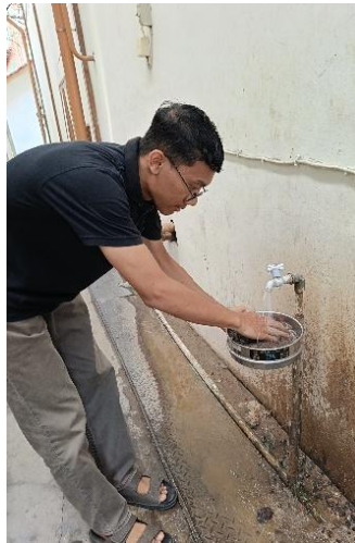
Gambar L.4.26 Mencuci Agregat dengan Saringan No.200
