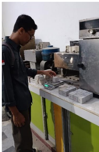
Gambar L.4.45 Menimbang Mortar yang Sudah di Oven
