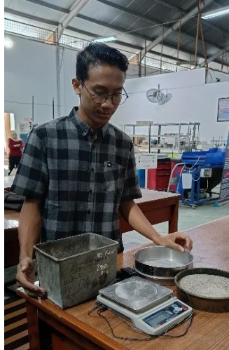
Gambar L.4.22 Alat dan Bahan Uji Kadar Air Agregat Halus
