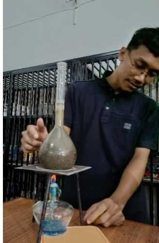
Gambar L.4.13 Memanaskan Piknometer Agregat Halus
