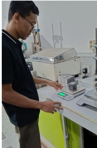
Gambar L.4.43 Menimbang Mortar Sebelum Oven
