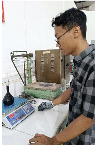
Gambar L.4.14 Menimbang Piknometer ACS dan ACK
