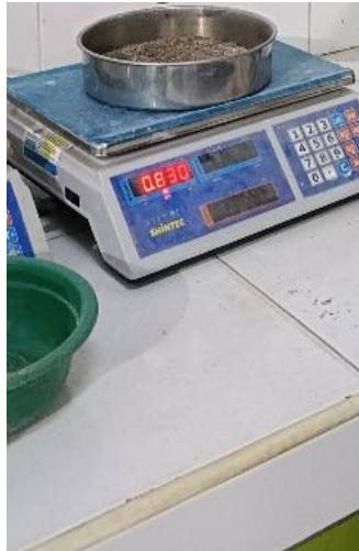
Gambar L.4.28 Menimbang Sampel Sudah Di Oven
