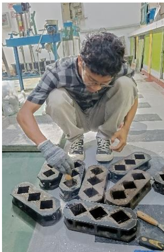
Gambar L.4.33 Mengoleskan Cetakan dengan Minyak
