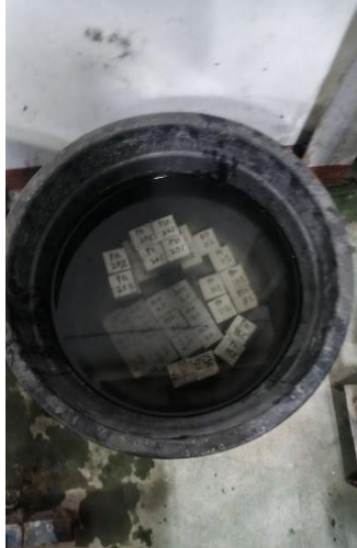
Gambar L.4.40 Masa Curing Selama 28 Hari
