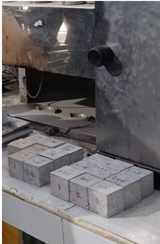
Gambar L.4.41 Mengeluarkan Mortar dari Bak Perendam
