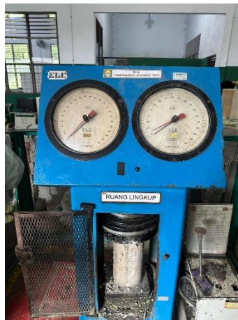
Gambar L-8: Kuat Tekan Beton
