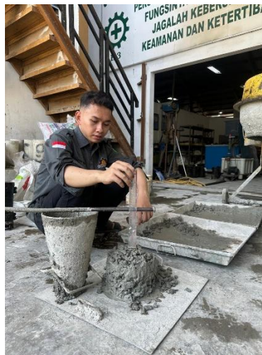
Gambar L-5: Mengukur nilai Slump
