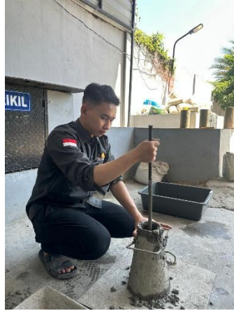
Gambar L-4: Memasukkan beton ke dalam uji slump
