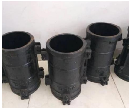
Gambar 3.9: Cetakan Benda Uji Beton
