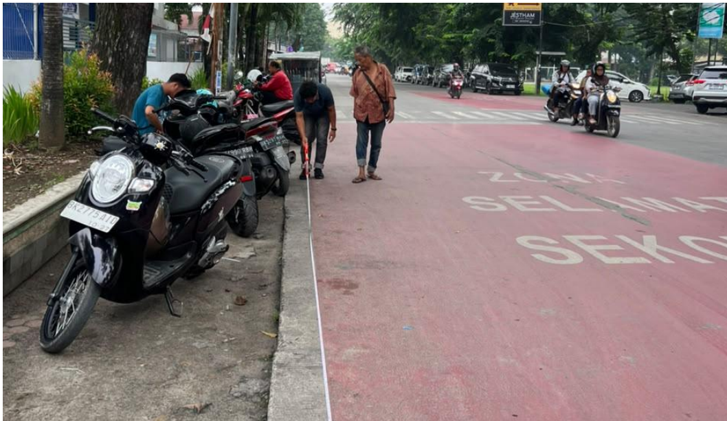
Gambar L.1: Perhitungan Geometrik Jalan
