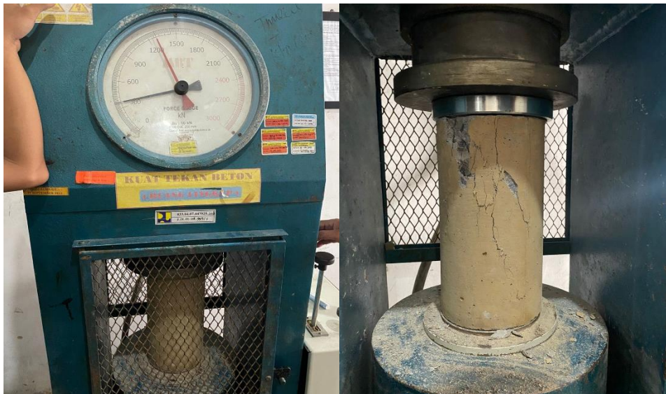
Gambar L.8: Pengujian kuat tekan beton.
