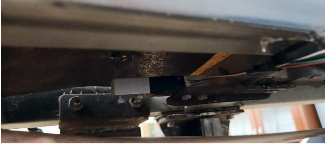
Gambar 4. 8 Neraca pada conveyor
