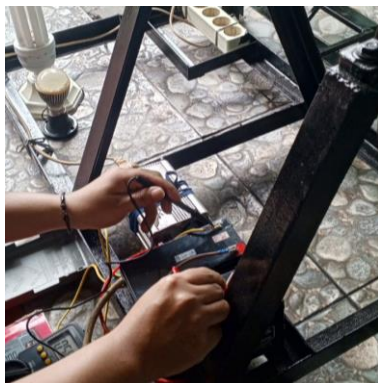
Gambar 4.1 Pengujian Bantrai dan Kecepatan putran Alternator
