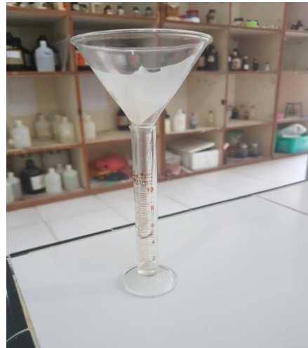
Proses Penyaringan dengan Kertas Whatman
