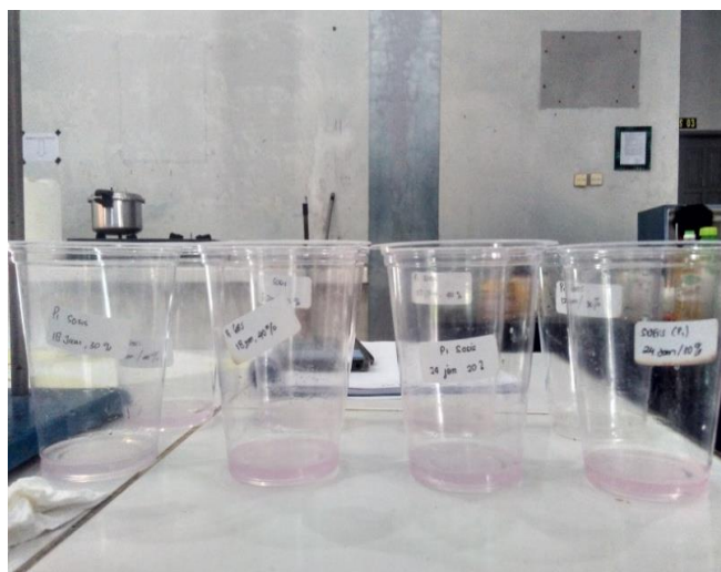
Gambar 33. Hasil Titrasi Bilangan Asam
