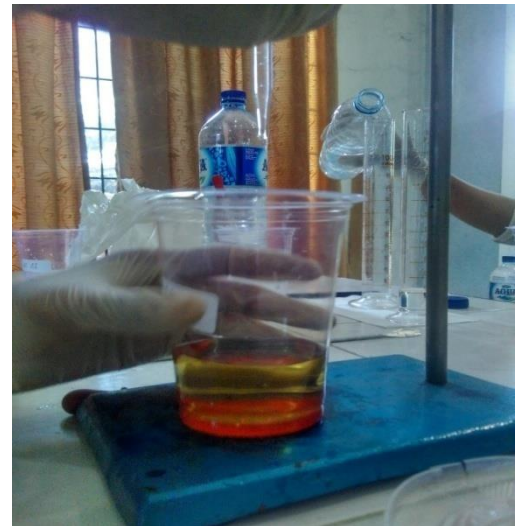
Gambar 31. Titrasi dengan \text{Na}_2\text{S}_2\text{O}_3
