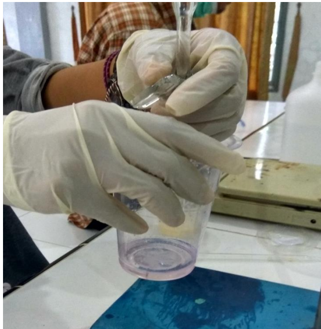
Gambar 32. Titrasi Minyak Sampai Muncul Warna Merah Jambu
