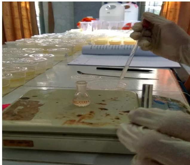
Gambar 27. Penimbangan Bobot Jenis Minyak/Lemak
