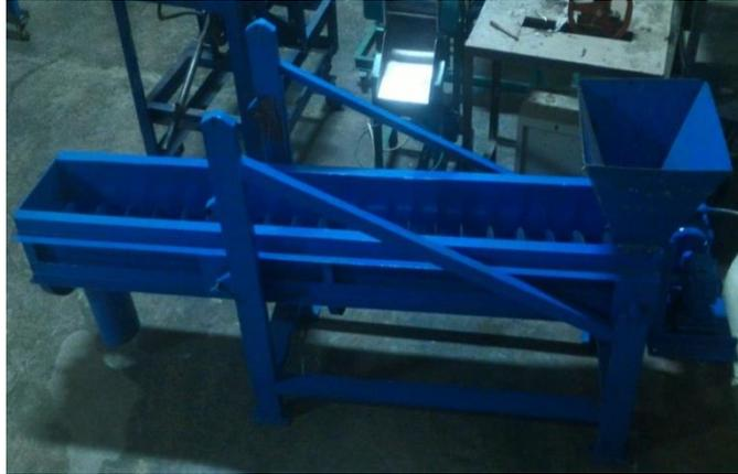
Gambar 4.3 Hasil dari desain mesin *screw conveyor* yang telah dibuat
