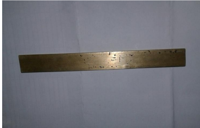
Gambar 3.11 spesimen bahan kuningan
