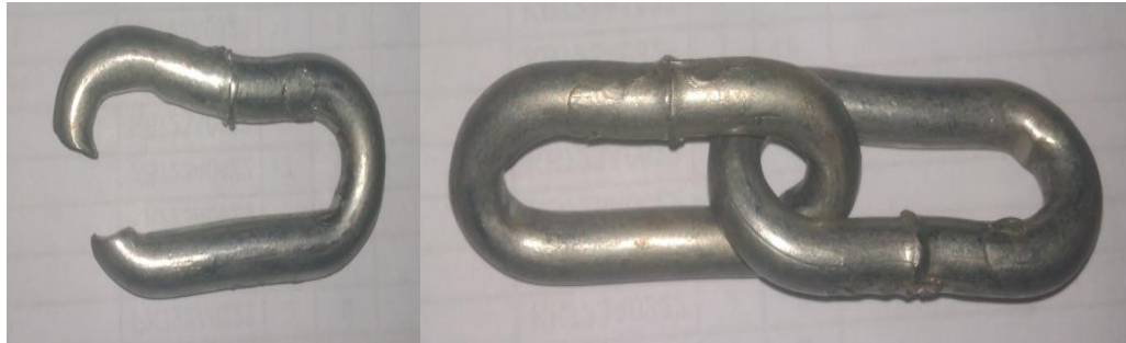
Gambar 4.1 spesimen setelah di uji tarik
