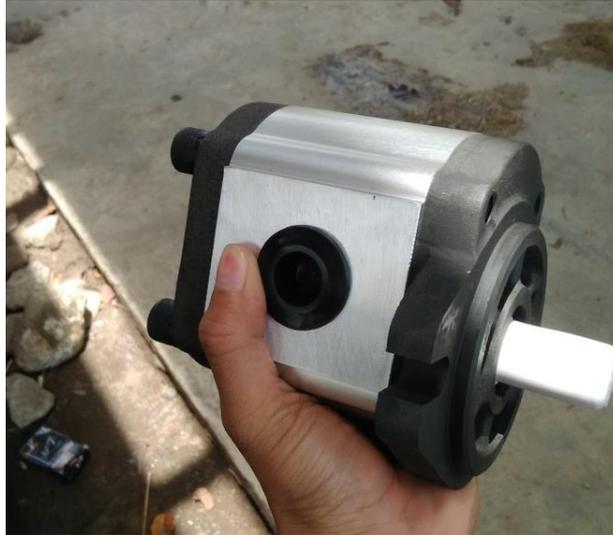
Gambar 3.8 Pompa Hidrolik
