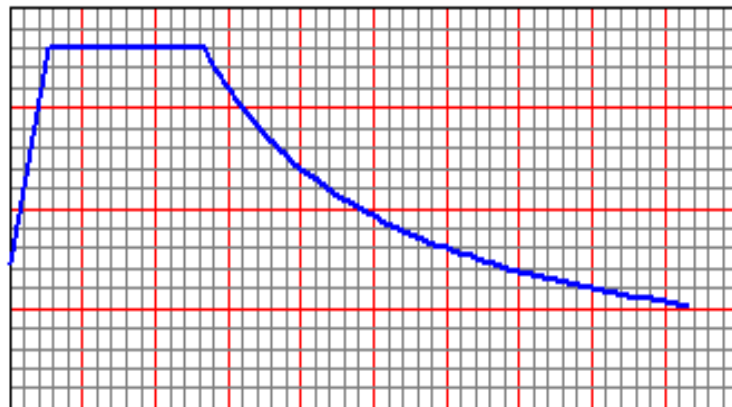
Gambar 3.19 : Grafik respons spektrum pelabuhan Malahayati untuk tanah lunak.
