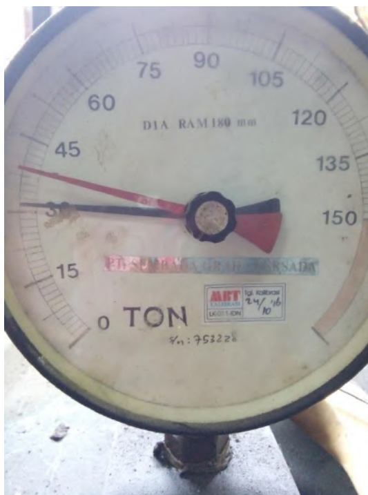
Gambar L15: Uji kuat tekan beton campuran serbuk kulit pisang 3% 7 hari: 39 T.
