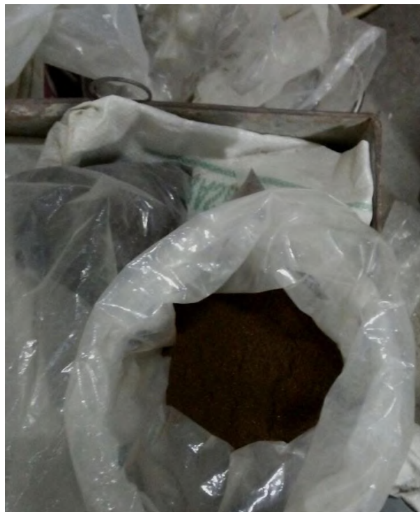
Gambar L4: Serbuk kulit pisang yang sudah di saring lolos 50.
