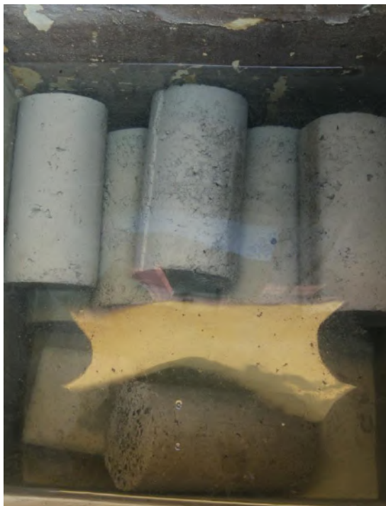
Gambar L10: Proses perendaman benda uji.
