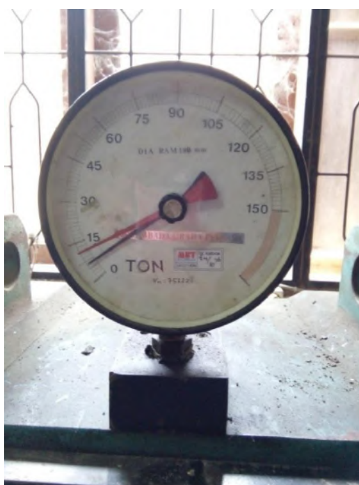
Gambar L16: Uji kuat tekan beton campuran serbuk kulit pisang 7% 7 hari: 12 T.
