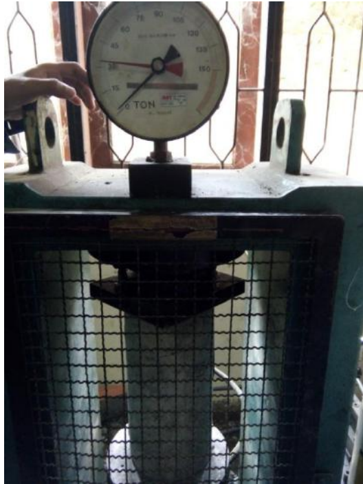
Gambar L13: Hasil proses uji tekan pada beton.
