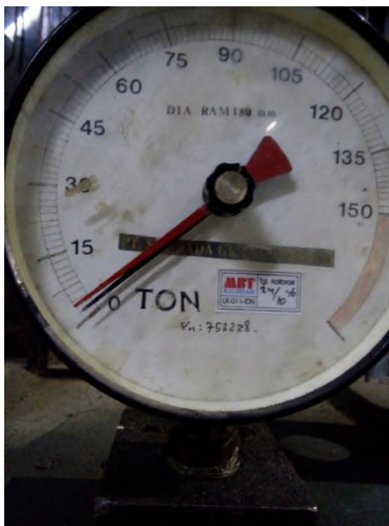
Gambar L17: Uji kuat tekan beton serbuk kulit pisang 10% 7 hari: 3,5 T.
