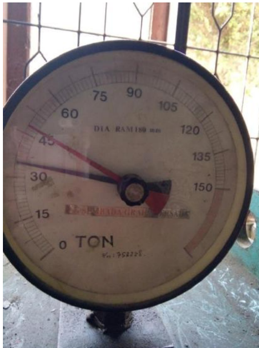
Gambar L14: Uji kuat tekan beton normal 7 hari: 48 T.
