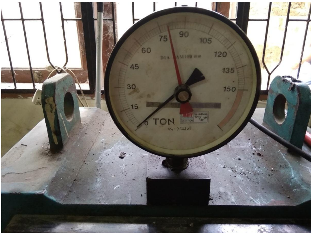
Gambar L13: Uji kuat tekan beton normal 28 hari: 79,5.
