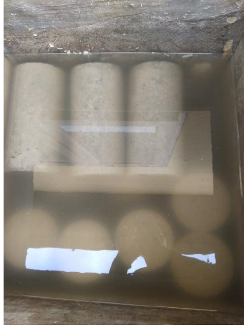
Gambar L10: Proses perendaman benda uji.
