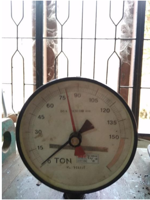
Gambar L14: Uji kuat tekan beton campuran abu ampas tebu dan botol kaca 2% + 5% 28 hari: 81,5 T.
