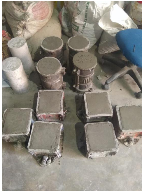
Gambar L9: Proses pencetakan beton.
