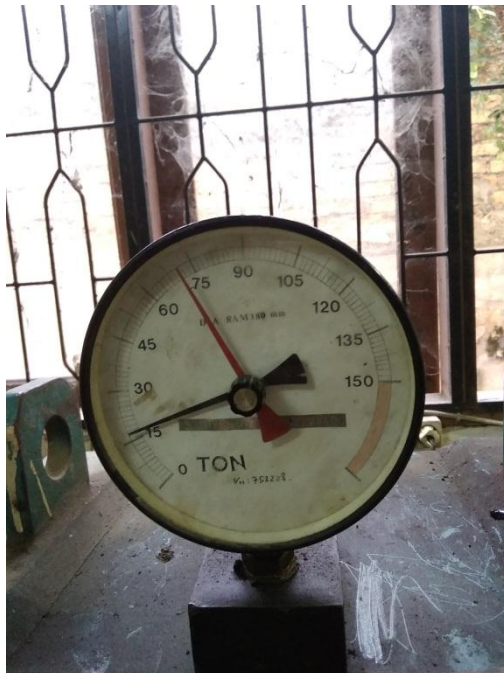
Gambar L15: Uji kuat tekan beton campuran abu ampas tebu dan botol kaca 2% + 10% 28 hari: 72 T.
