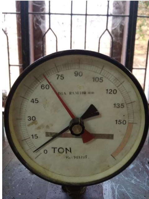
Gambar L16: Uji kuat tekan beton abu ampas tebu dan botol kaca 4% + 5% 28 hari: 65 T.
