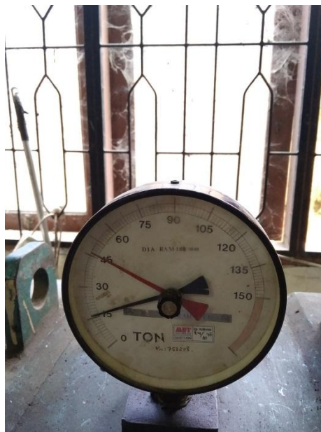
Gambar L17: Uji kuat tekan beton campuran abu ampas tebu dan botol kaca 2% + 10% 28 hari: 46,5 T.
