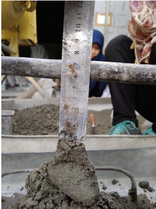
Gambar L8: Proses pengujian slump .
