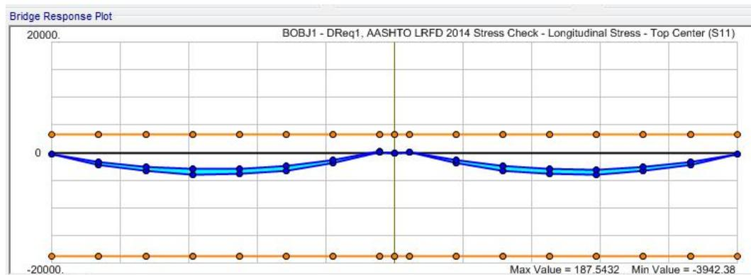
Gambar L.39: Cek kekuatan terhadap *pier* bulat dengan analisis CSI V17.
