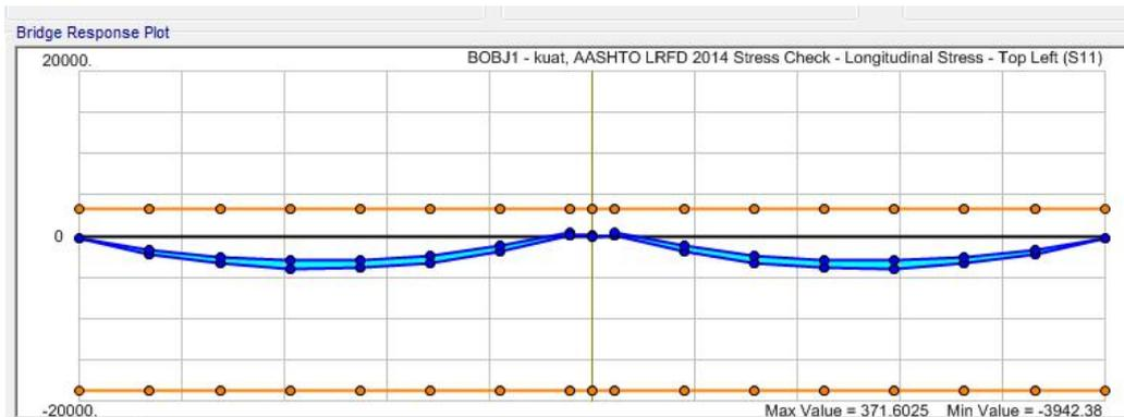
Gambar L.41: Cek kekuatan terhadap *pier* kotak dengan analisis CSI V17.
