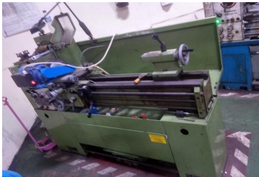
Gambar 4.9. mesin gerinda silindris yang dipasang pada mesin bubut.
