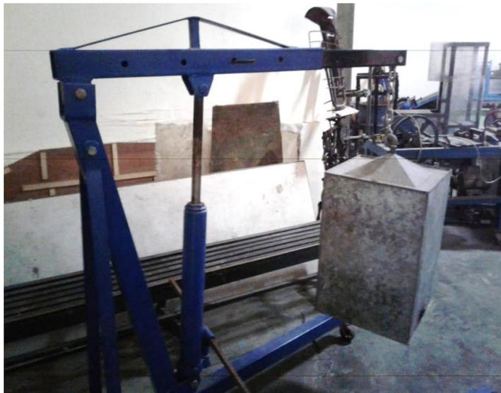
Gambar 4.1 Mini Crane Ketika Mengangkat Beban.
