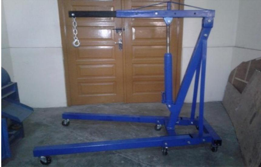
Gambar 3.2. *Mini crane portable* kapasitas 1 ton.
