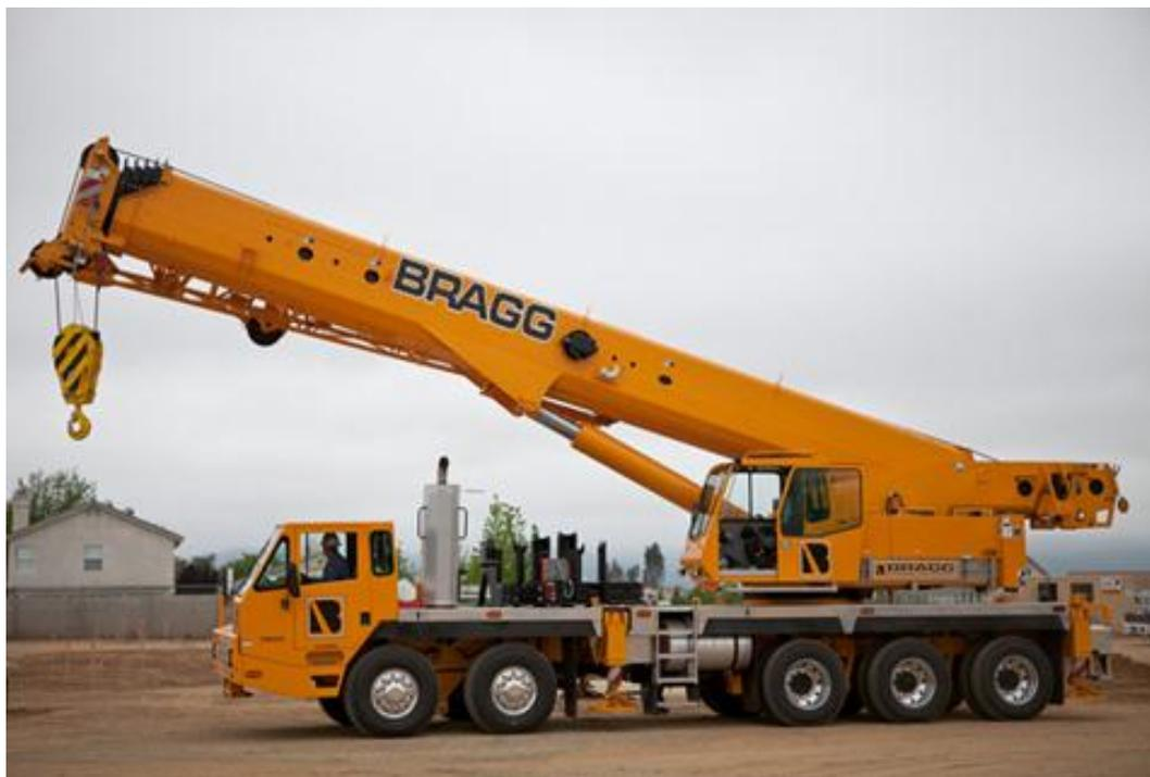
Gambar 2.4. *Crane* tanpa lintasan.
