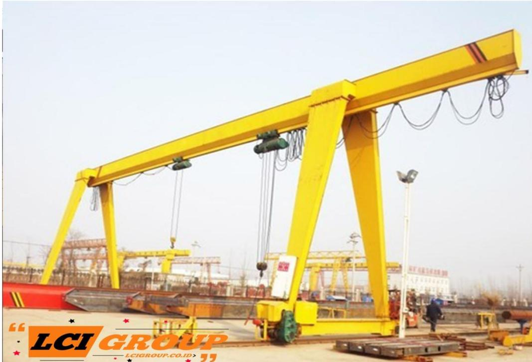
Gambar 2.3. *Crane* yang bergerak pada rel.
