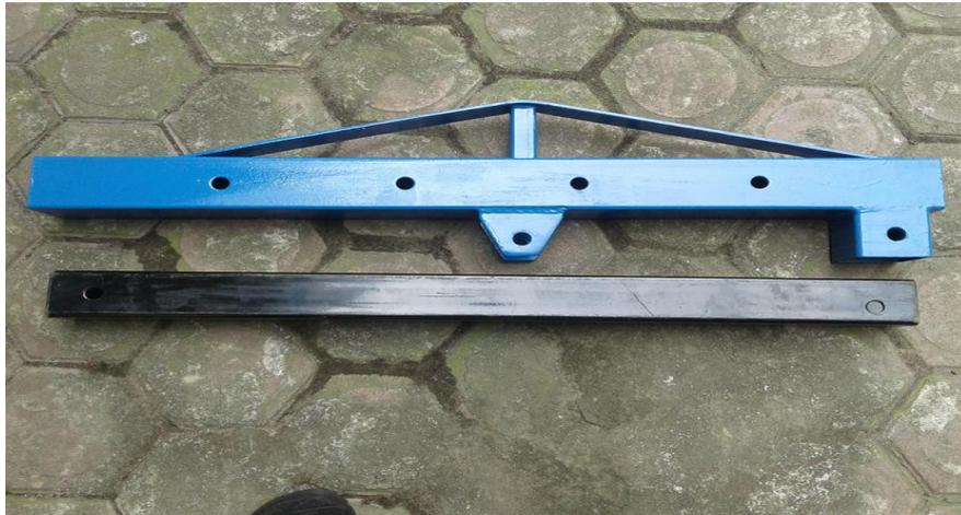
Gambar 3.1. Lengan *crane* dan lengan *boom teleskopik*.
