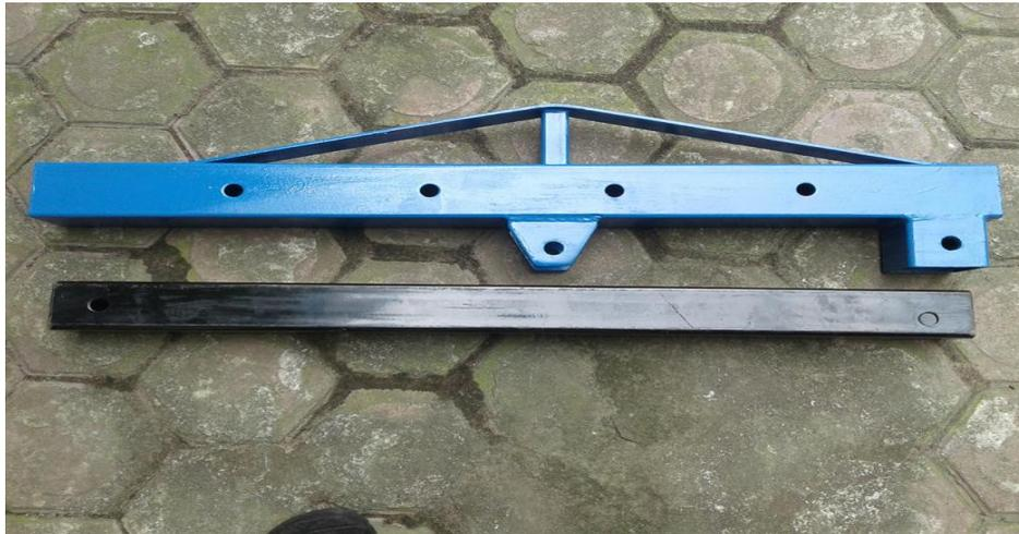
Gambar 3.8. Lengan *Crane* dan lengan *boom teleskopik*.
