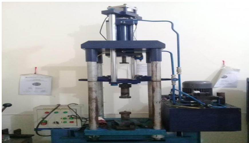
Gambar 3.10 Proses pengujian tarik dan tekan statis
