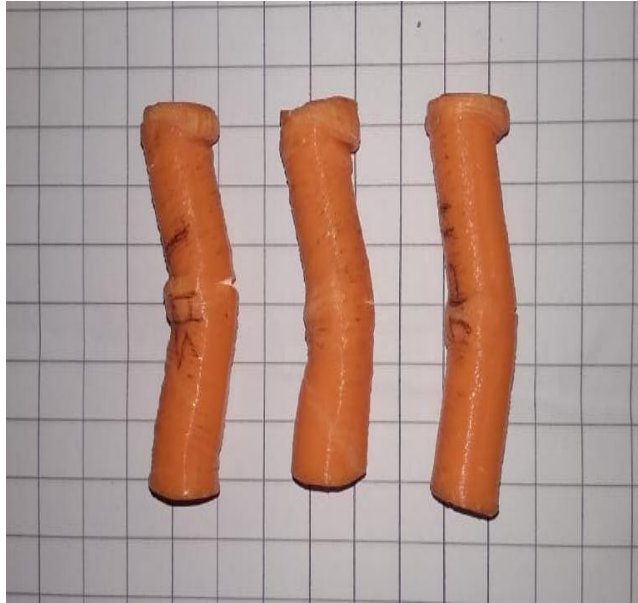
Gambar 4.25 Spesimen ABS hasil uji tekan
