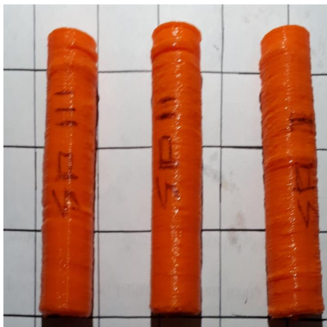
Gambar 4.24 Spesimen uji tekan filament ABS
