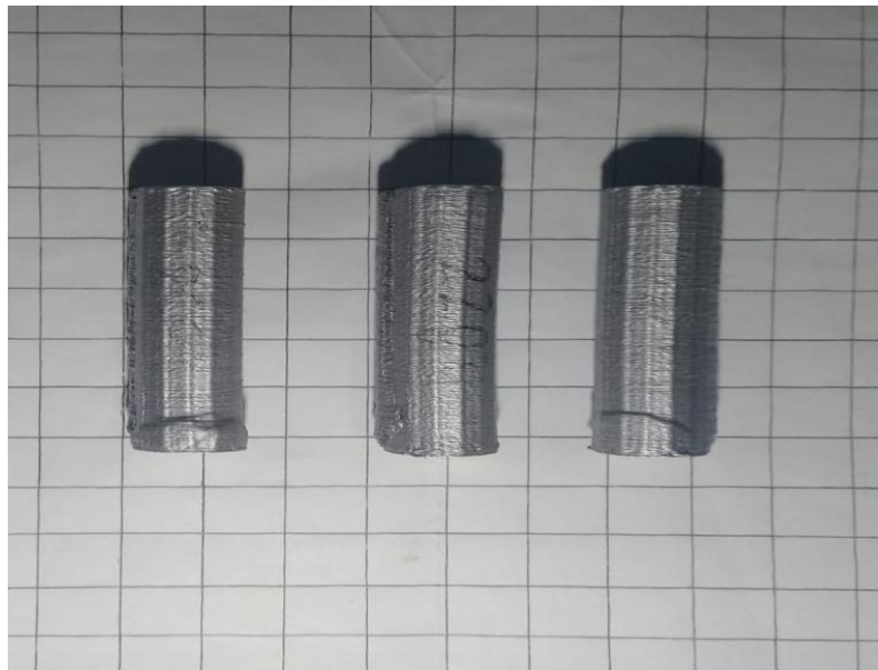
Gambar 4.18 Spesimen PLA hasil pengujian tekan
