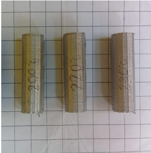
Gambar 4.17 Spesimen Uji Tekan PLA
