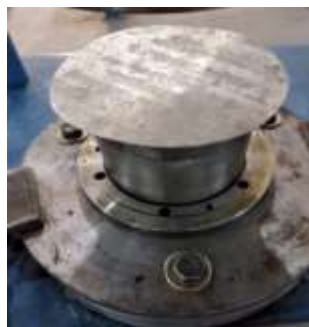
Gambar. 3.14 Blank yang akan diuji pas berada ditengah cetakan.
