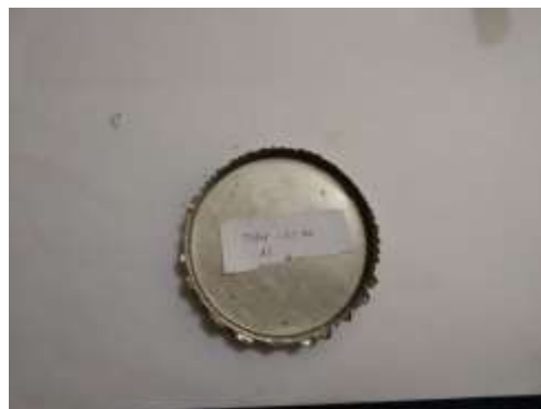
Gambar 4.6 Gambar hasil pengujian spesimen 3 dengan ketebalan 0,5 mm
