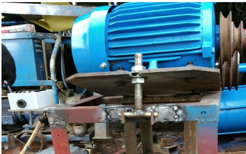
Gambar 4.9. Dudukan Penyetel Motor Listrik dan *Pulley*
