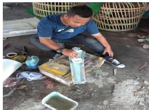
Gambar 4.5 pemasukan dan pengolesan cairan fibreglass ke dalam cetakan
