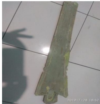
Gambar 4.4 Cetakan Yang Akan Digunakan Untuk Pembuatan Sudu
