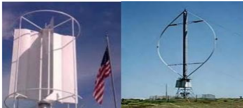
Gambar 2.3 Varian turbin angin sumbu vertikal
