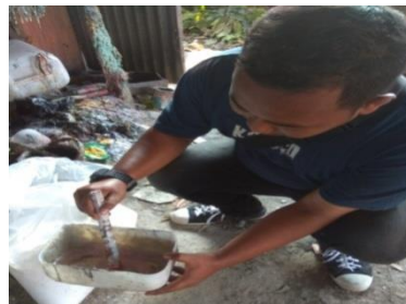
Gambar 4.4 proses pembuatan cairan fibreglass
