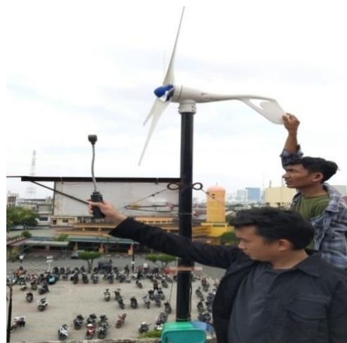
Gambar 4.14 mengukur kecepatan angin
