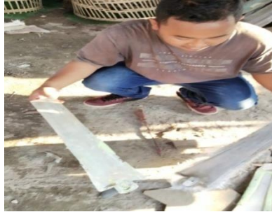
Gambar 4.6 pembukaan cairan fibreglass dari cetakan
