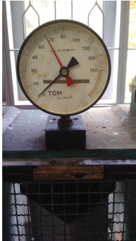
Gambar L11: Hasil proses uji tekan pada beton.
