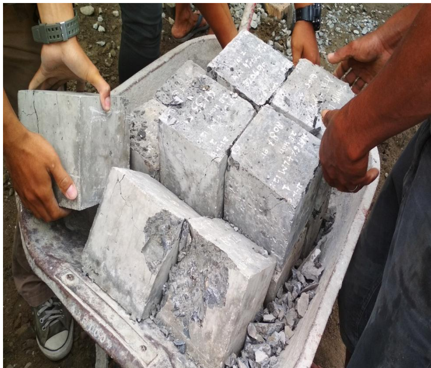
Gambar L6: Benda uji setelah dites kuat tekan.
