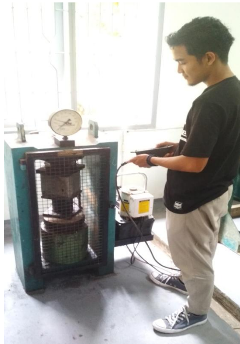
Gambar L12: Proses kuat tekan beton.
