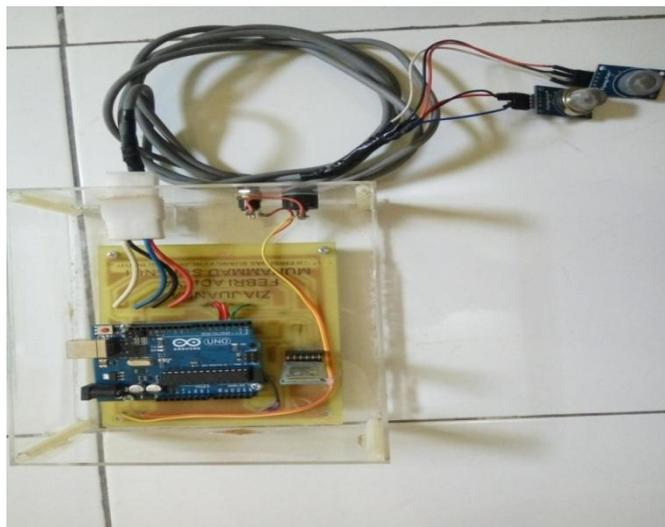
Gambar 4.3 Alat Rancangan Uji Emsi Gas Analyzer Buatan Sendiri
