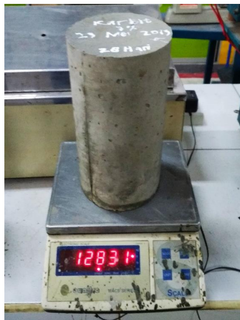
Gambar L.13. Salah satu benda uji variasi limbah karbit.
