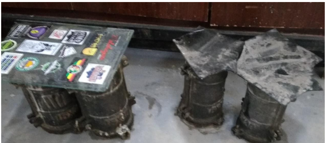
Gambar L.9. Adonan beton yang sudah dimasukkan ke dalam cetakan dan didiamkan selama 24 jam.
