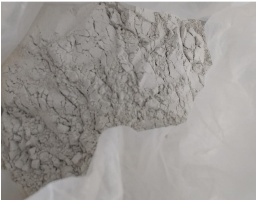
Gambar L.4. Limbah karbit setelah dilakukan penyaringan lolos saringan no.200.
