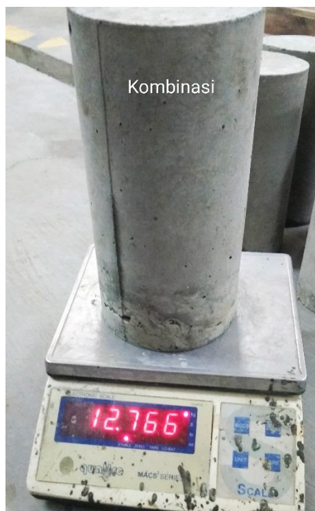
Gambar L.15. Salah satu benda uji kombinasi limbah karbit dan limbah kaca.
