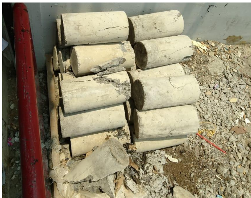
Gambar L.23. Kehancuran benda uji setelah pengujian kuat tekan beton.
