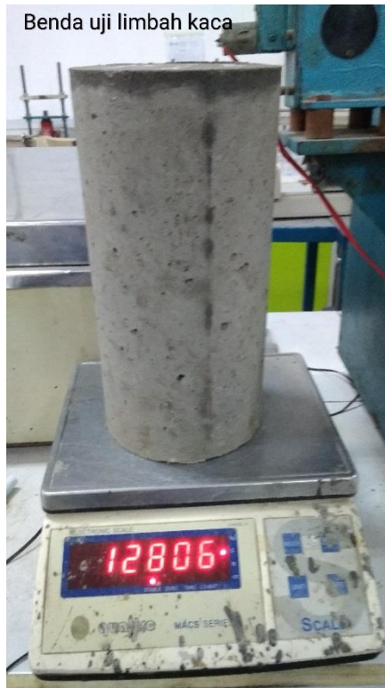
Gambar L.14. Salah satu benda uji variasi limbah kaca.
