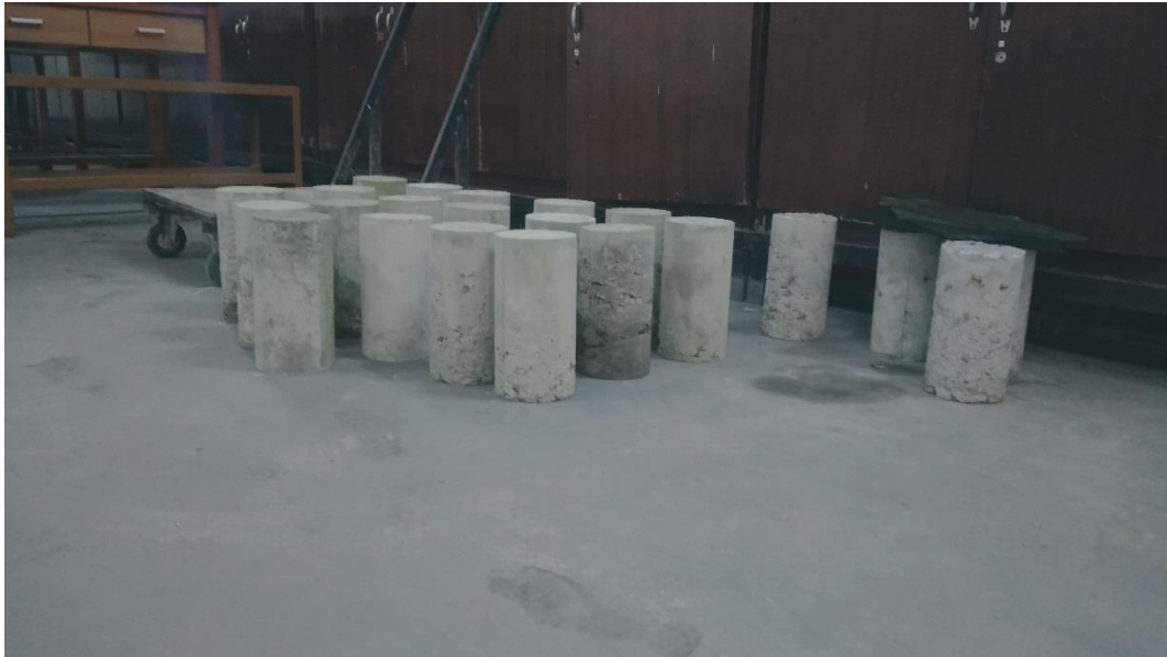
Gambar L.10. Benda uji yang telah dilepaskan dari cetakan.
