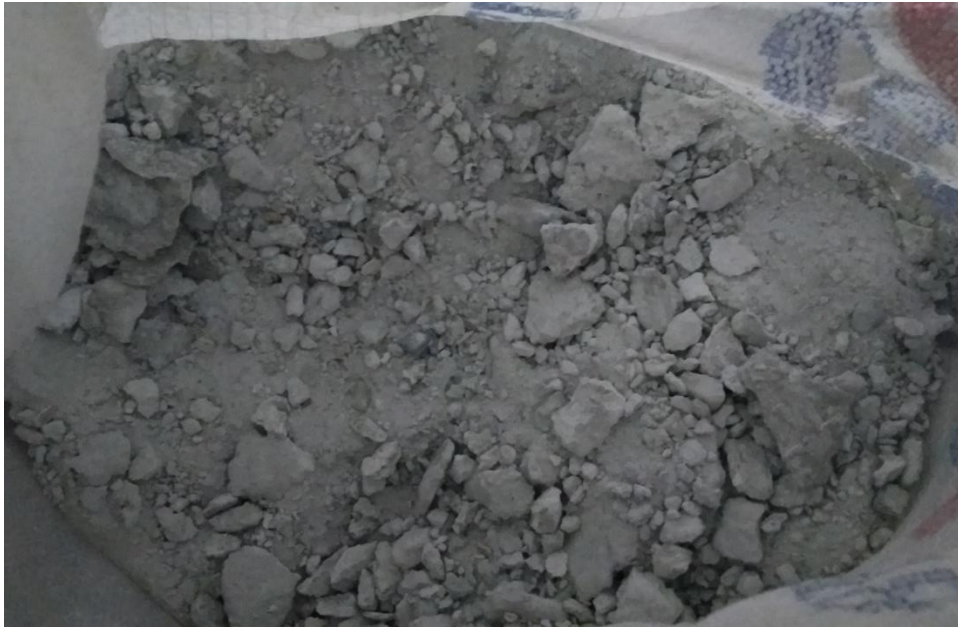
Gambar L.3. Limbah karbit sebelum dihaluskan dan disaring.
