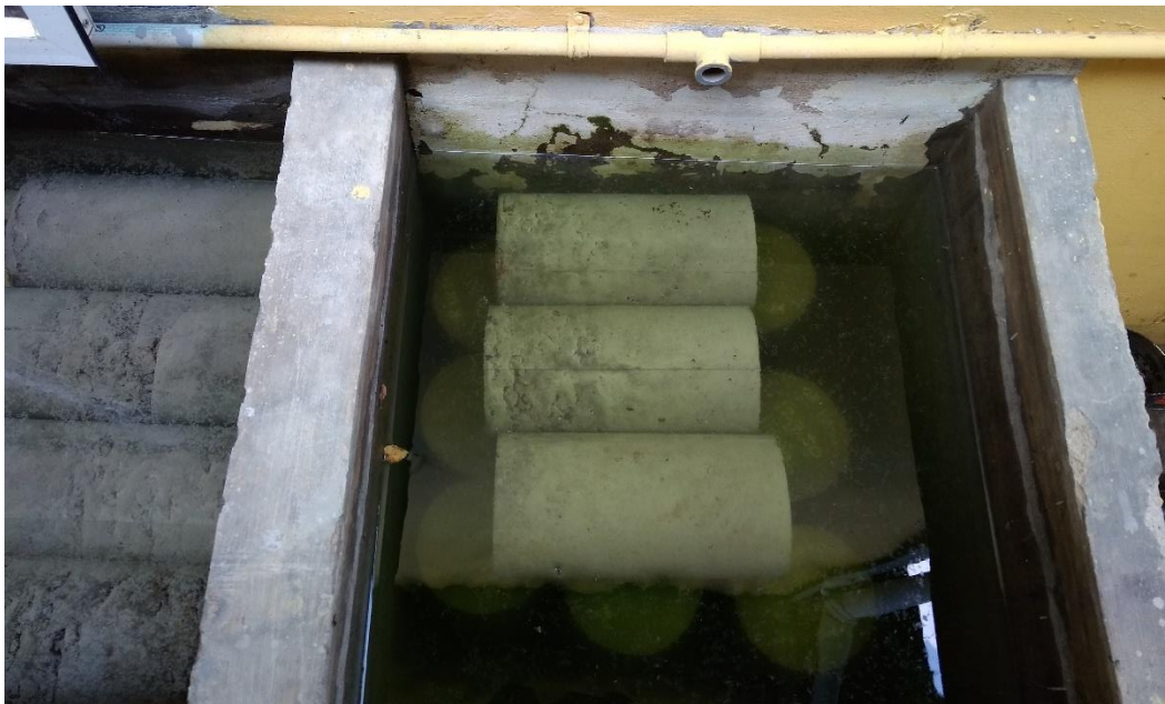
Gambar L.11. Perendaman benda uji.
