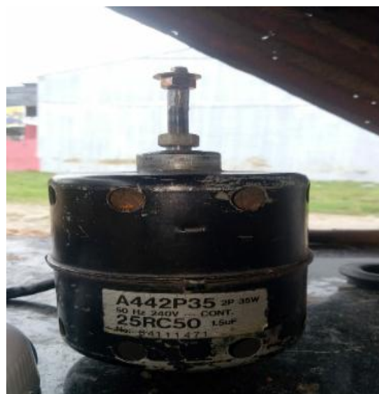
Gambar 3.18. Motor Fan Indoor AC
