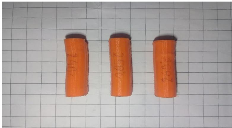
Gambar 4.24 Spesimen ABS hasil uji tekan
