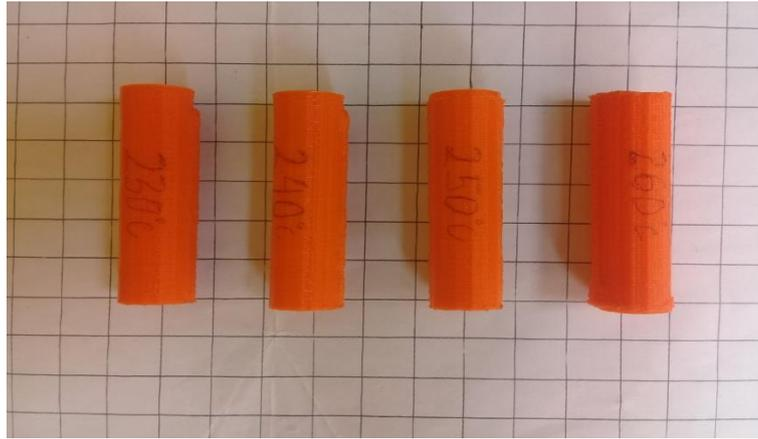
Gambar 4.23 Spesimen uji tekan filament ABS
