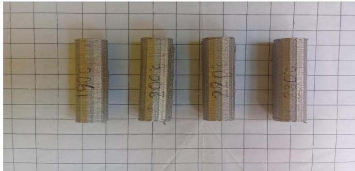
Gambar 4.16 Spesimen Uji Tekan PLA
