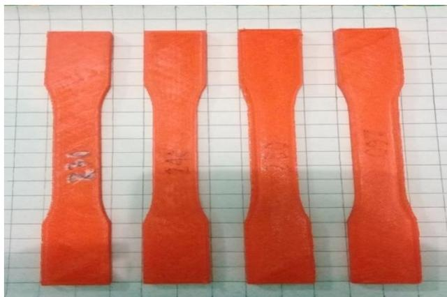
Gambar 4.8 Spesimen uji tarik filament ABS
