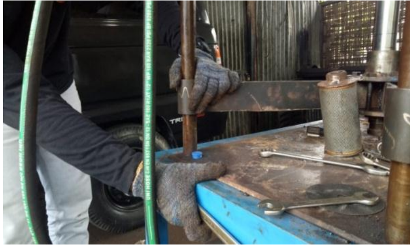
Gambar 4.25 Pemasangan Spindle Silang 4
