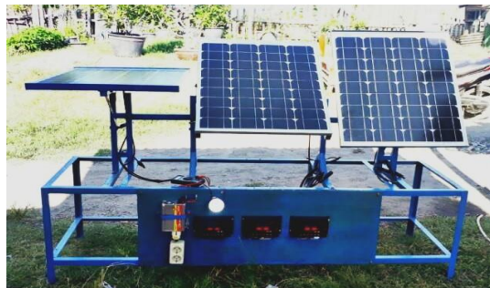
Gambar 3.35 Pengujian Panel di Tempat Terbuka
