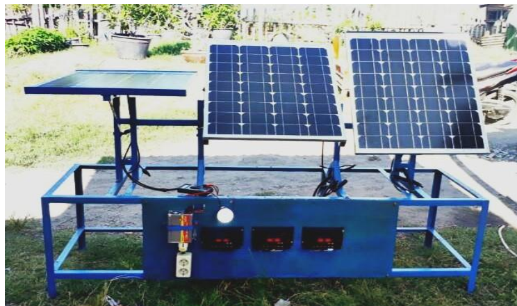
Gambar 4.1 Pembangkit listrik tenaga surya dengan sudut 0°, 40°, 60°.
