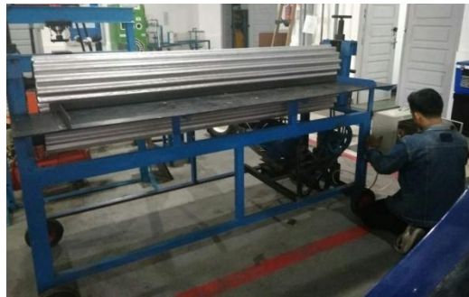
Gambar 4.15 Pemasangan panel kontrol pada mesin roll sheet metal pada model bergelombang
