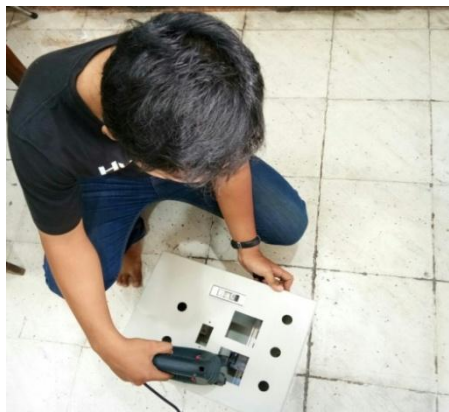
Gambar 4.6 Hasil pemotongan plat sesuai pola yang telah dibentuk
