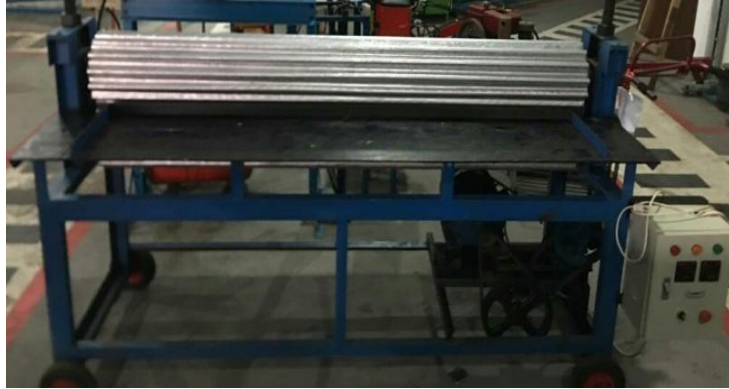
Gambar 4.21 hasil pemasangan panel kontrol pada mesin roll sheet metal pembuatan genteng model bergelombang
