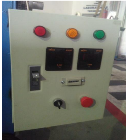
Gambar 4.19 Hasil perakitan awal box panel kontrol pada mesin roll
